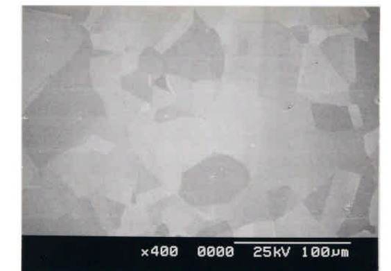
SEM: EPコイルチューブ内表面 SEM: Inner Surface of EP COILED TUBE
