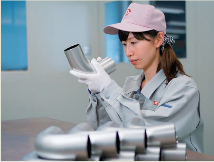
最終総合検査 (精密洗浄前) Final inspections (Before super mechanical cleaning)
