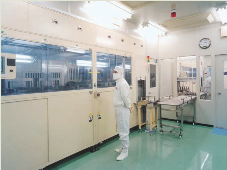
R0洗浄室 クラス10,000 (0.3 \mu m) (ISO14644-1 クラス7相当) R0 Cleaning room Class 10,000 (0.3 \mu m) (ISO14644-1 Class7)
