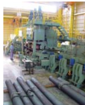
大口径管冷拔设备 (400A) Cold Draw-Bench up to 400A
