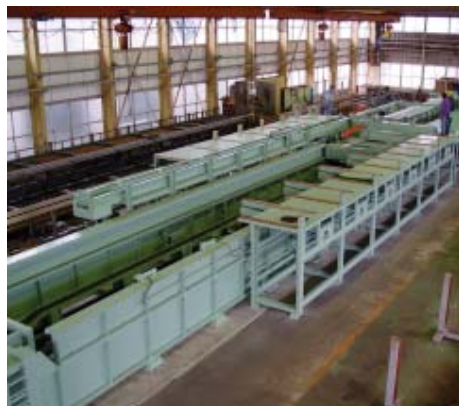
大口径管冷拔设备 (400A) Cold Draw-Bench up to 400A
